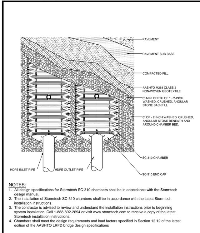
**SWM-1** **STORMTECH SC-310 CHAMBER SYSTEM PLAN VIEW DETAIL**
